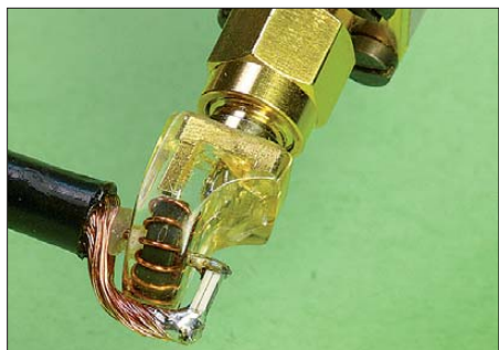
Bild 6: Kalibrieraufbau für den VHF-Wandler
