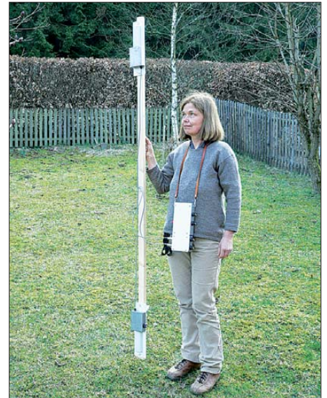
Bild 2: Für die genauere Untersuchung einer kleinen Fläche ist die gestockte Anordnung der Sensoren gut geeignet. Sollen eng beieinander liegende Objekte verfolgt werden, ist eine Verringerung des Sensorabstands vorteilhaft.
