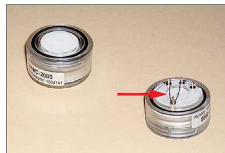
Bild 2: Erst direkt vor der Bestückung der Platine mit dem Sensor ist die Kurzschlussbrücke auf seiner Rückseite zu entfernen.
