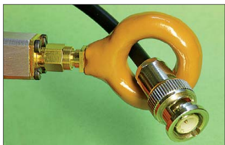
Bild 5: Mit dem KW-Stromwandler lassen sich auch Mantelströme auf Kabeln messen.
