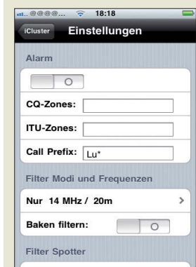
iCluster: Da eine Verbindungsrichtung Argentinien auf der angenommenen Wunschliste steht, wurde im Feld 'Call Prefix' „LU“ eingetragen.
