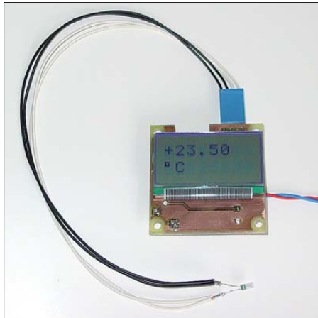
Bild 1: Thermometerplatine mit aufgesetztem Display und Sensor im Vordergrund
