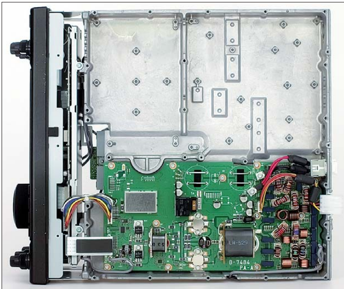
Bild 4: Blick von unten in das geöffnete Gerät; unten im Bild der Platz, bei dem sich im IC-9100 die optionale 23-cm-Einheit UX-9100 nachrüsten lässt.
