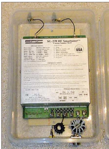
Bild 5: Der Antennenkoppler SG-239 befindet sich hier zusammen mit Mantelwellensperre und Buchsen in einer Plastikbox.
